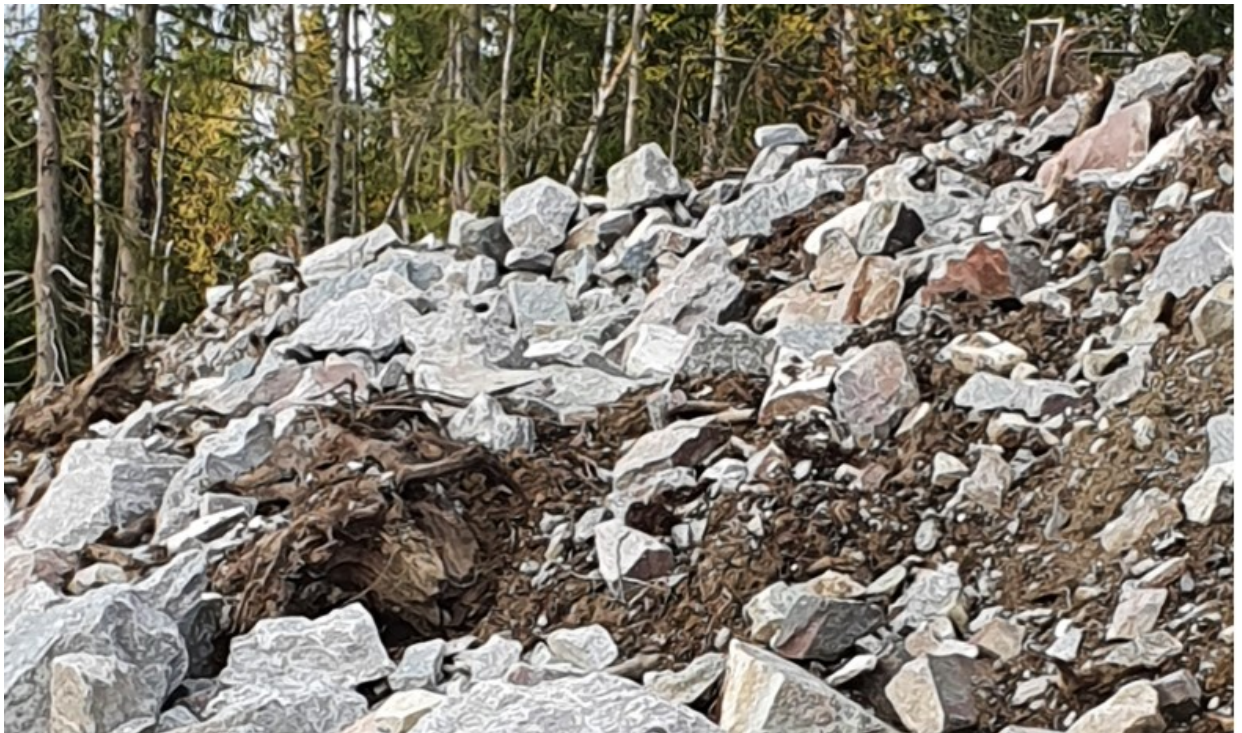
Bilde 9. Eksempel på vekstmasser som er blandet med sprengstein. Omfattende sortering må til før vekstmassene kan benyttes.
