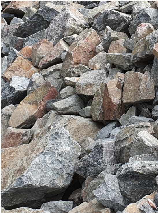
Bilde 10. Eksempel på grove masser som bør mettes med før vekstmassene legges ut.
